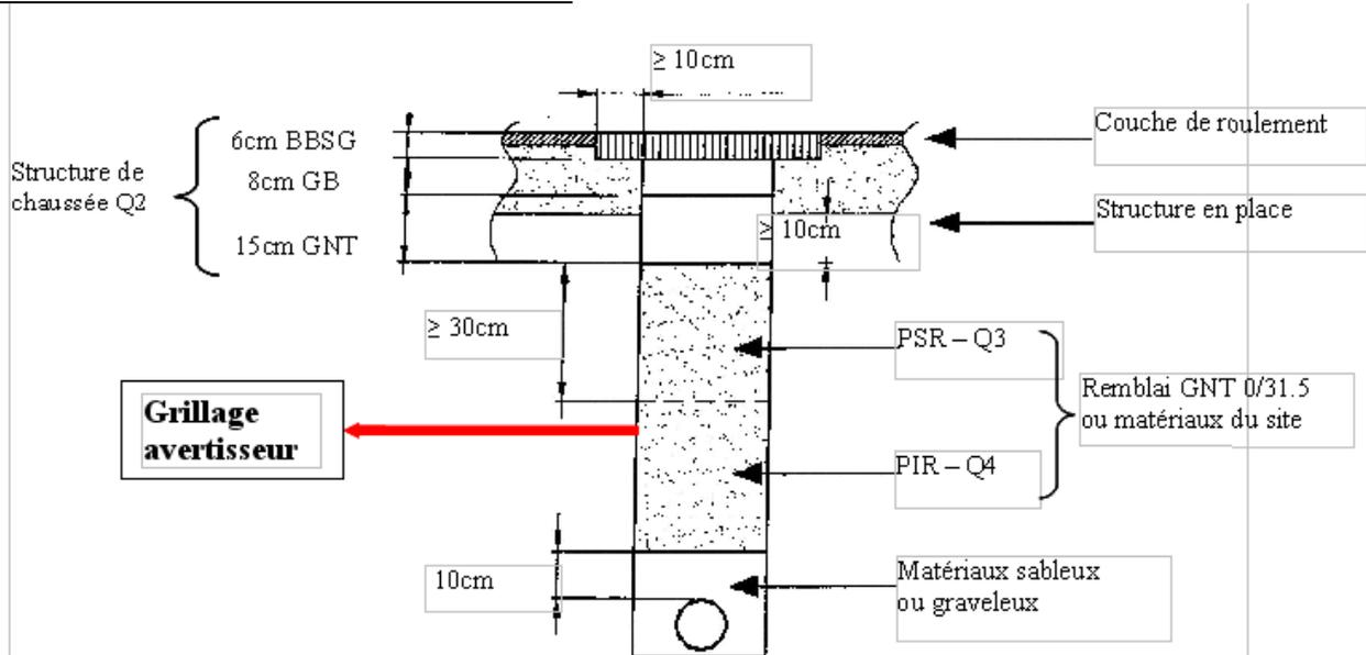
La partie inférieure de remblai (PIR), qui n'existe que dans les tranchées profondes, doit avoir une épaisseur au moins égale à 15 cm, sinon, on l'assimile à la partie supérieure du remblai (PSR). Dans le cas de tranchées étroites ( $\leq 30$  cm), la GNT 0/31,5 du remblai sera remplacée par de la GNT 0/10.
